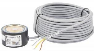
Sensoren har en NTC-motstand som måler temperaturen på sensorens overflate. Sensorens varmeelement og to metallringer måler fuktighet.
