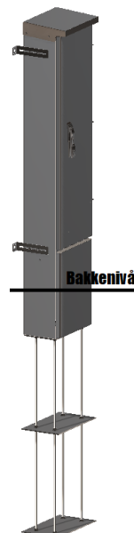
Figur 2: Ferdig planert bakkenivå skal være ca. midt på nedre frontdeksel.
